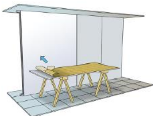
C Retirer 20-30cm du film protecteur de l'adhésif et faire adhérer de manière uniforme sur la plaque de plâtre.
